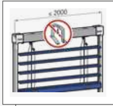
Construction de stores autoporteuse
